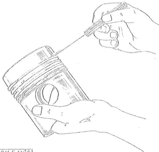
Abb. 03-40 Kontrolle des Spiels des Kolbenringes in den Nuten des Kolbens
